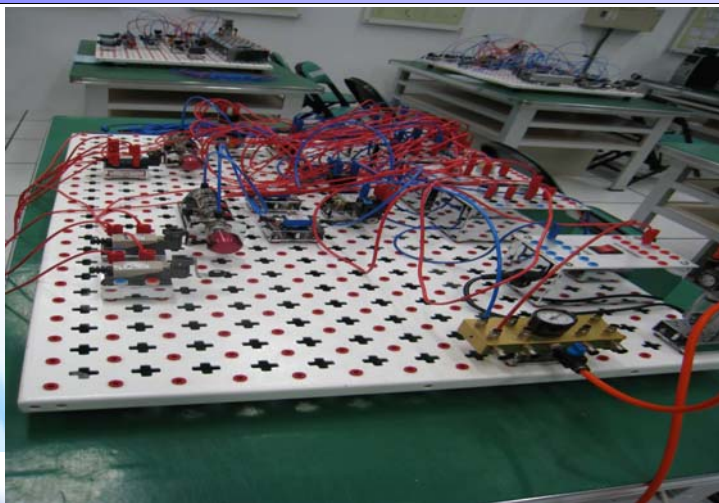
圖示為氣壓丙級檢定及訓練設備 滿足兩單位共12人次測試
