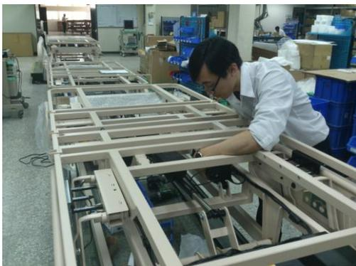
電動病床電動螺桿安裝
