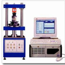
■ (三) 拉拔力測試機
