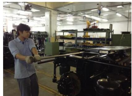
圖 3 第五輪固定螺絲上緊扭力
