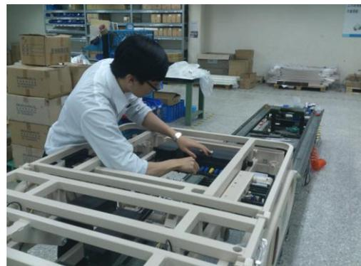
電動病床螺桿控制器安裝
