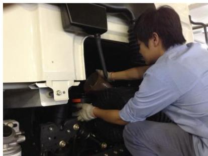
圖 2 添加二次動力方向機油
