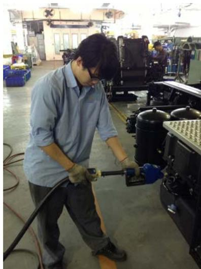
圖 2 添加還原型觸媒(SCR)系統之尿素
