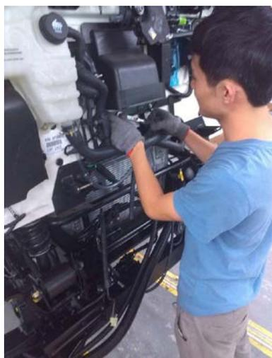
圖 1 忠文同學安裝車頭端冷氣系統
