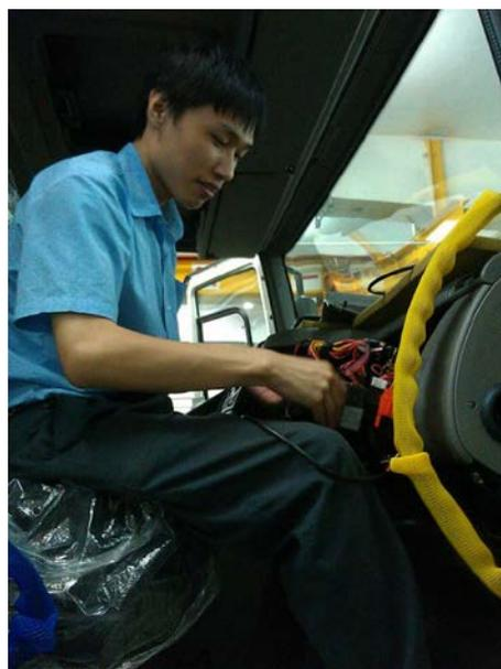
圖 2 檢查車用電腦配線線路
