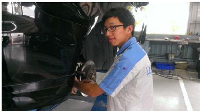
圖 1 文林同學更換剎車來令片實習照片
