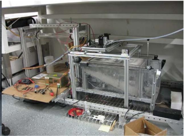
正在架設之 Selective Laser Sintering 機檯
