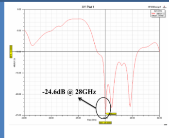
天線量測後在28GHz具超低損耗。
