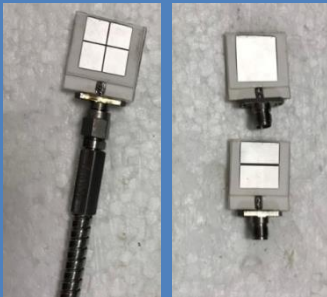
已製作出的多層堆疊式LTCC天線晶片 (28GHz -> 5G範圍)
